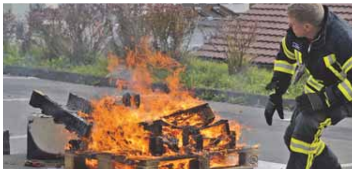
600 glühend heiße Grad am Tresor - doch der Inhalt ist nicht einmal leicht erhitzt worden. sub-Bild: us
