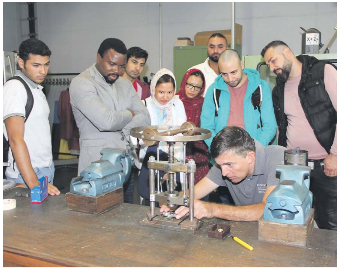
Fertig ist der erste Fidget Spinner in der Feinwerkmechanik-Werkstatt. Lehrmeister Bernd Linder (vorn) presst vor den Augen der arbeitssuchenden Geflüchteten und des Integrationsbeauftragten der Stadt Engen, David Tchakoura (2.v.l.), das Kugellager ein.
