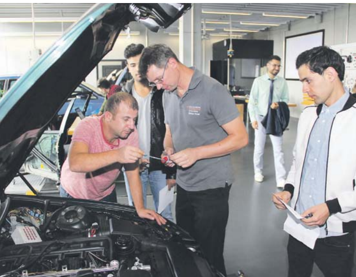
In der Kfz-Lehrwerkstatt analysiert Feras Aljamli aus Syrien (links) gemeinsam mit Lehrmeister Markus Moser (mittig) die Kühlflüssigkeit per Refraktometer. Sein Landsmann Mohamed Brim und der aus Afghanistan stammende Sameer Amini schauen interessiert zu.
